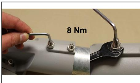
18. Die Neigung der Leuchte mithilfe der Schrauben am Gelenk auf die gewünschte Position einstellen. Empfohlener Drehmoment 8Nm.
