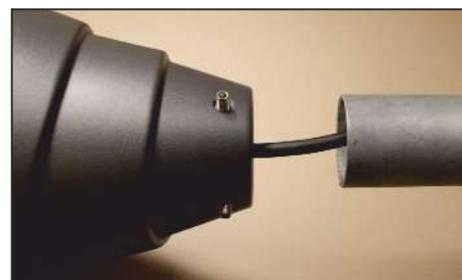
10. Die Leuchte mit vier Schrauben befestigen. Empfohlener Drehmoment 8Nm.
