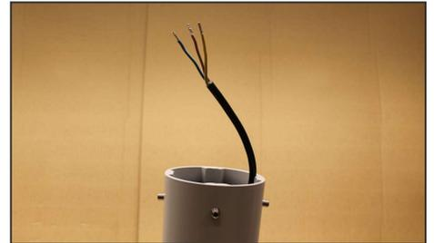
3. Das 3-adrige Kabel an die Stromversorgung anschließen.
