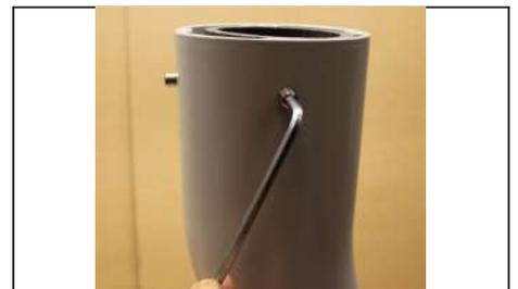
9. Das Zwischenstück von der Leuchte entfernen. Die Leuchte auf einen Mast aufsetzen und dann mit Schrauben befestigen. Empfohlener Drehmoment 8Nm.
